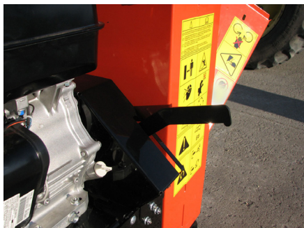
Figura 3.1, Posición de salida correa desacoplado
