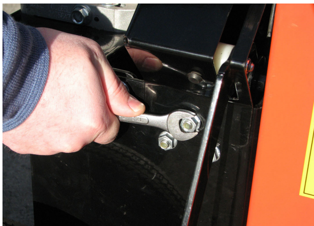
Figura 5.9, Retiro de la protección de la correa
